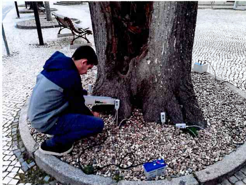
Figura 15 – Análise com recurso ao resistógrafo e tomógrafo na Tília N°2.
